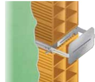
A staffa fica chumbada na parede e não permite que a porta se desloque.
