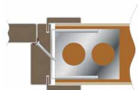
A **STAFFA TECNICO** com o seu regulador denominado **CAVALLOTTO**, permite fixar a porta ou o batente de maneira rápida corrigindo qualquer imperfeição da parede.
